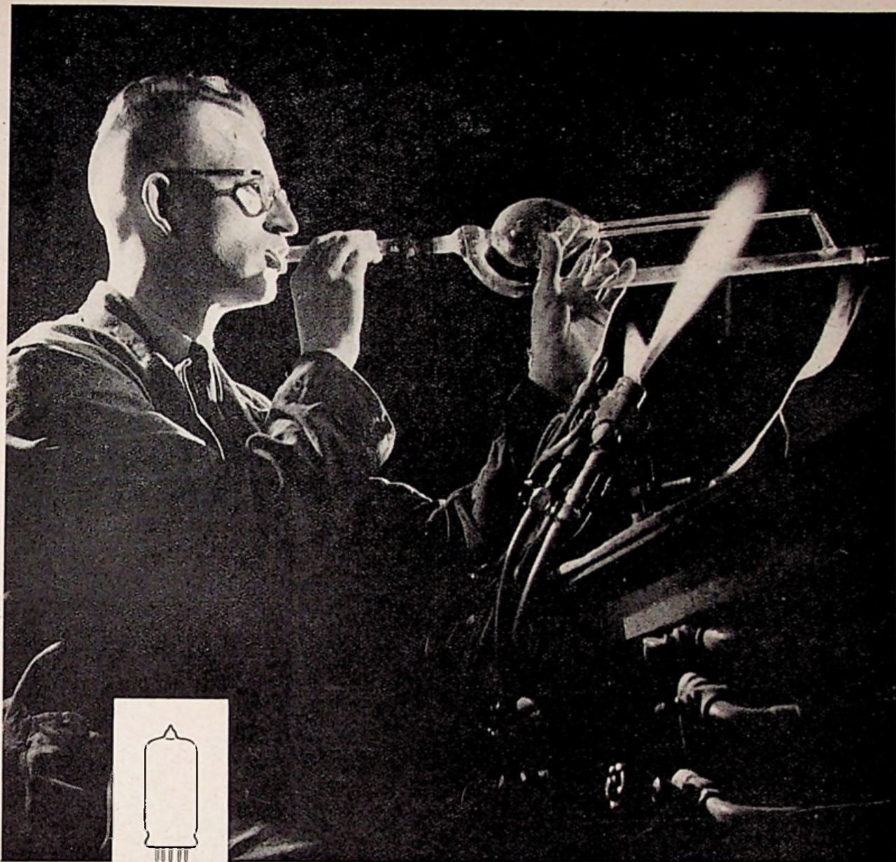
Het blazen van een glasballon voor een prototype.
